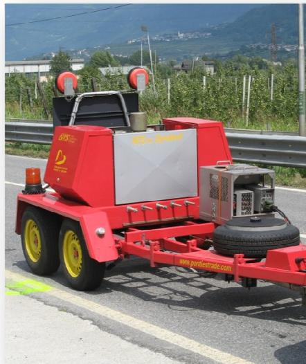
L'apparecchiatura è in grado di applicare diverse condizioni di carico attraverso la regolazione dell'altezza di caduta della massa battente combinata al carico di contrasto utilizzato.
